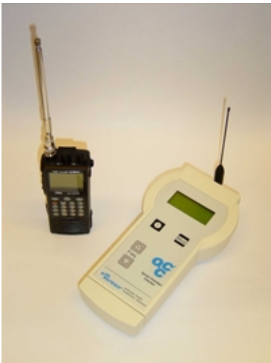
Bild 4 Quick Chamber Checker QCC der Fa. emscreen, ein einfach zu bedienender Prüfsender. Zusammen mit einem Handempfänger (im Lieferumfang) dient er zum schnellen und einfachen Aufspüren von Lecks in geschirmten Räumen.
